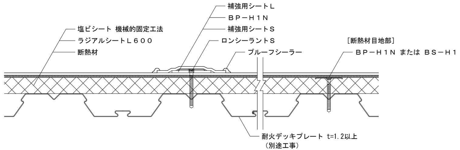
※ 断熱材の種類が硬質ウレタンフォームの場合、ラジアルシート L600 の敷設は不要
