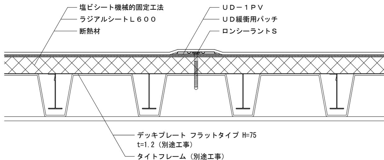
※ ラジアルシートL600は、断熱材の種類がポリスチレンフォームの場合のみ使用
