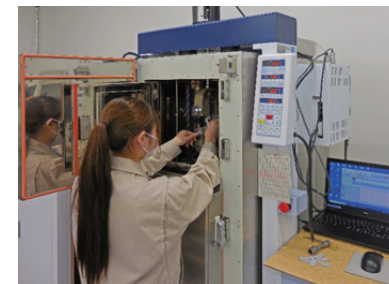
品質確認の様子(引張試験)
