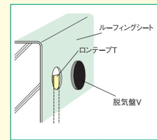
**特長** 通気構造の塩ビ成型盤で、ルーフィングと一体化できます。
