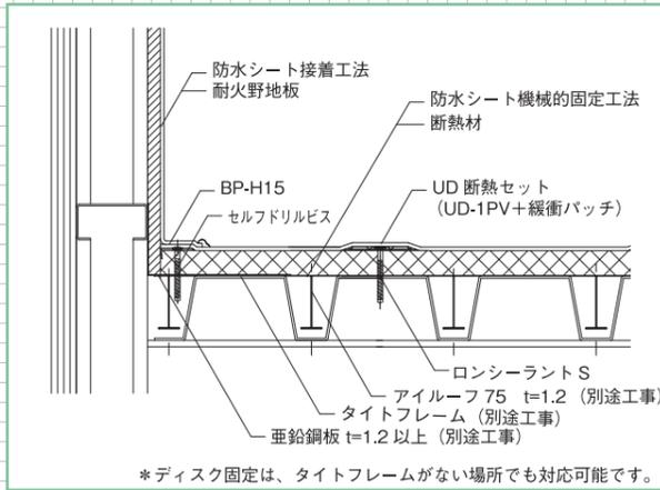
平場 (US工法)・立上り機械的固定工法
