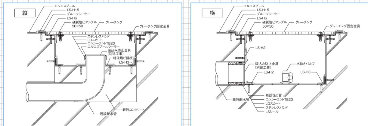
※排水柵部の形状に応じ、グレーチングを支える補強をお願いします。
