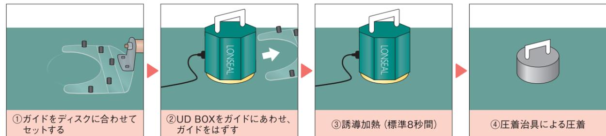
UD BOX I・II・IIIともに回路の保護・オーバーヒート防止の為、1回の加熱と加熱の間は20秒程度間隔をあけてください。UD BOX IIIでは、1回の加熱終了後、15秒程度加熱できない仕様になっています。
