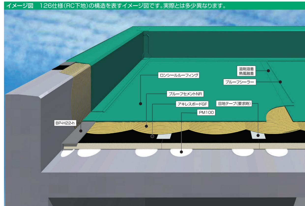
※鋼板、断熱材の固定は、プラグ・ビスを併用する場合があります。
