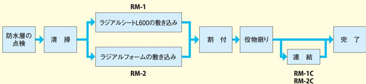
RM-2工法・RM-2C工法で断熱材にポリスチレンフォームを使用する際には、ラジアルシートL600を敷き込んだ上に、断熱材を敷き込んでください。
