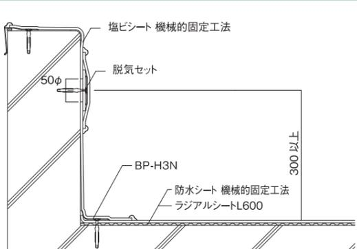
110仕様 (脱気盤V立上り接着工法用)
