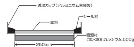
【試験方法】 透湿面250mm角のカップに試験体を取り付け、「温度23℃/湿度50%」の条件で静置し、塩化カルシウムに吸湿された重量を測定し、透湿度・透湿抵抗を求めた。
