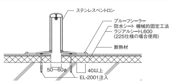
210仕様 (脱気セット立上り機械的固定工法用)
