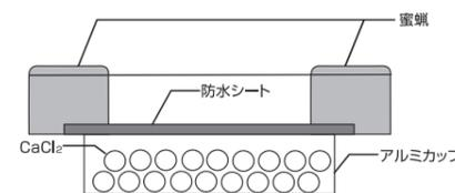
【試験方法】 透湿面60mmφのカップに試験体を取りつけ、「温度40℃/湿度90%」の条件で静置し、塩化カルシウムに吸湿された重量を測定、透湿度を求めた。
