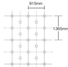
パネル同士は、5~7mmの隙間を空けて施工してください。
