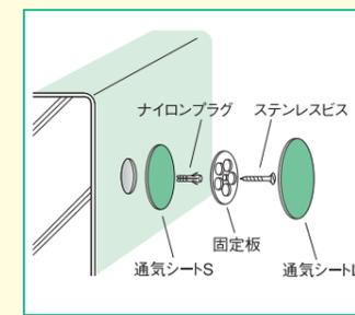
**特長** 通気加工処理を施した円形の塩ビシートを用い、防水層と一体化することができます。
