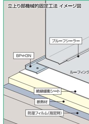
※改修工事で立上り機械的固定工法の場合には、立上り面防水シートの下に絶縁緩衝シートが必要になります。
