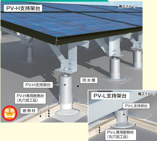
露出防水工法設置時
