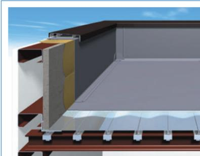
屋根30分耐火認定を取得したデッキプレート(フラットタイプ)であれば、耐火建築物として使用できます。
