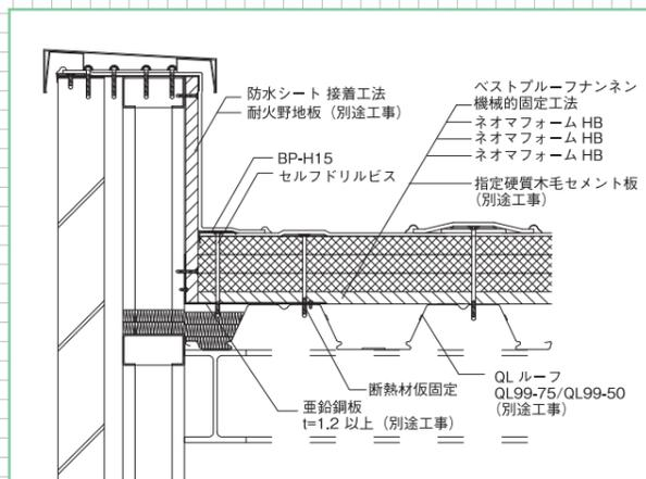
平場部 (UD工法)/立上り部 (機械的固定工法)
