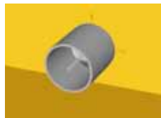
②スペーサーの取り付け (長ネジ締め込み)
