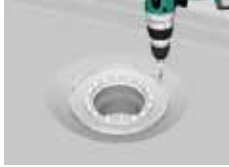
⑥防水層押えの固定
