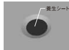
④養生シート貼り付け、 コンクリート打設
