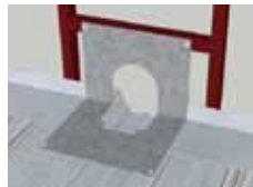
②補強鋼板の固定
