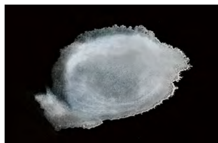
樹脂ワックスの耐エタノール試験結果 試験体：樹脂ワックスを塗布したビニル床シート 試験方法：JIS A 1454(23℃, 24h)
