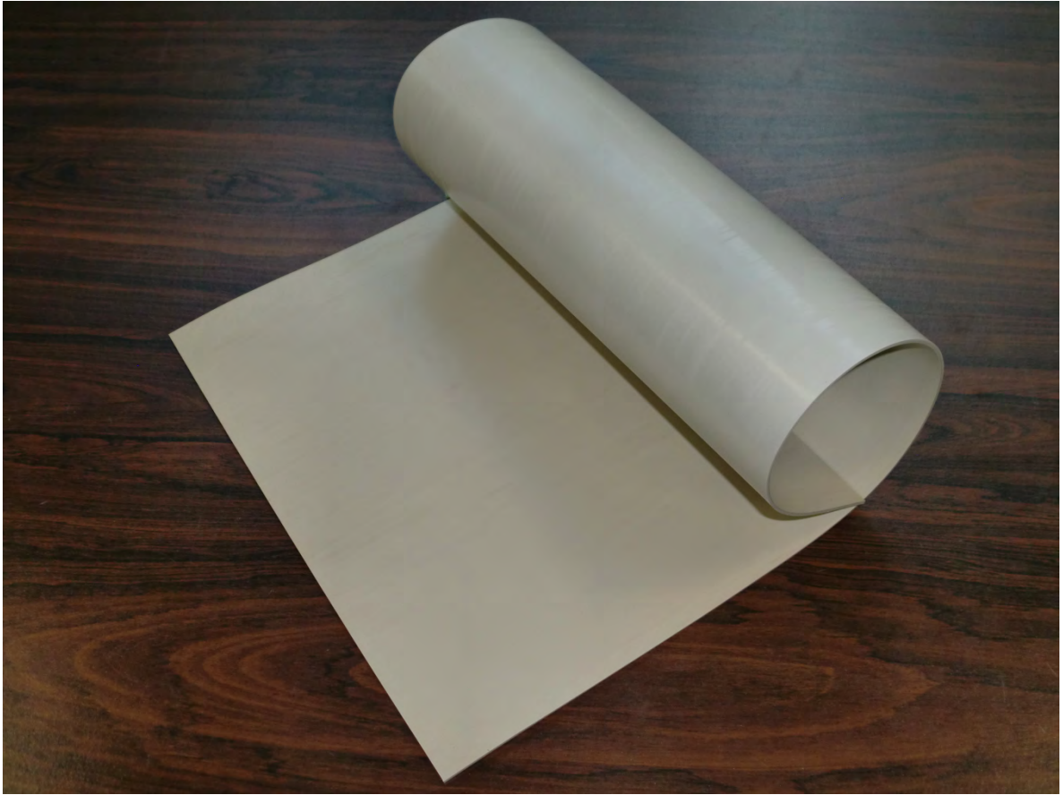
【写真 1】 開発した放射化抑制機能を持たせた床材
